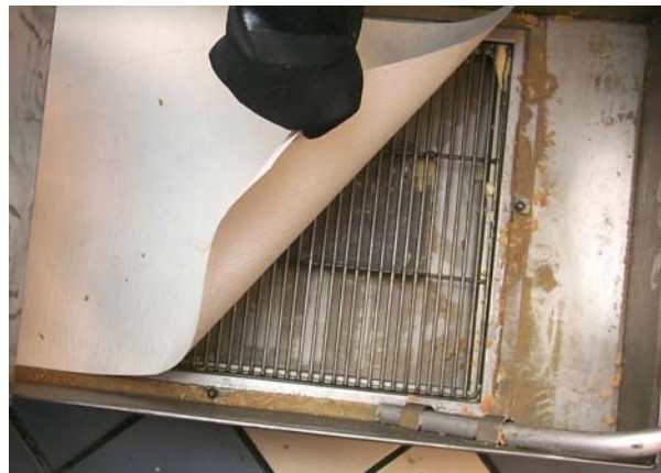
Ponga una hoja nueva de papel de filtro sobre la malla de soporte del filtro.
