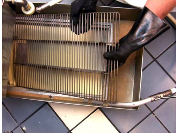
Extracción de malla de soporte de papel de la fuente.
