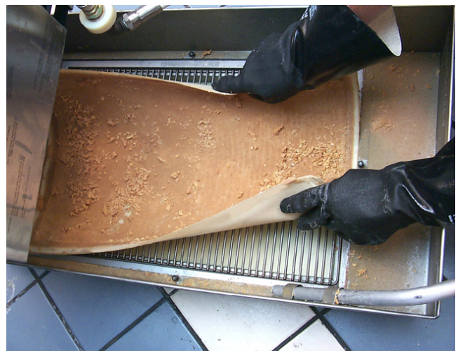
Extracción del papel de filtro sucio de la fuente.
