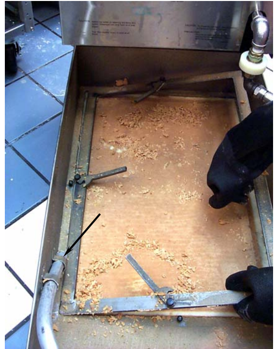
Extracción del aro de sujeción. Obsérvese la posición de la funda de la varilla (flecha).
